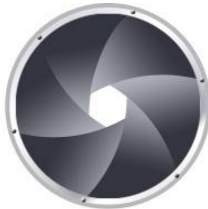
MALI OTVOR BLENDE (ulazi malo svetlosti) f/22
